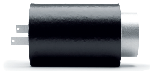
CI-F 80 med utvändigt ljudisolering och fästbleck. Invändig diameter/utvändig diameter: Ø80/120 mm. Håltagning: Ø125 mm från insida vägg och Ø85 mm genom den yttre delen av fasaden.
