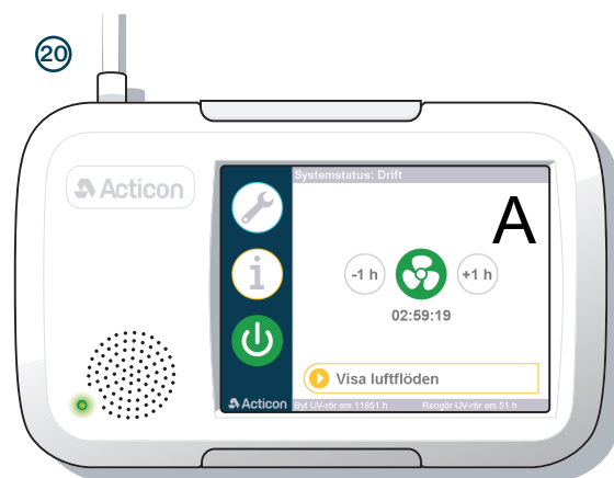
Grön fläktsymbol indikerar startad timer. Drifttid kan förkortas och förlängas med 1 timme. För att manuellt stänga av timern trycks den gröna fläktsymbolen in.
