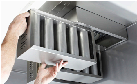
En filterkassett består av tio cykloner. Kassetten lyfts enkelt av för rengöring i diskmaskin
