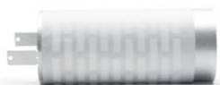
LJUDDÄMPANDE KANAL CV 80 Material: Aluzinkplåt Diameter 80 mm Håltagning: Ø85 mm Denna kanal är avsedd för utfackningsvägg
