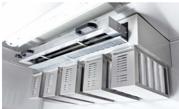
Figur 3 - Observera att trådnätsfiltret är placerat under UV-ramen
