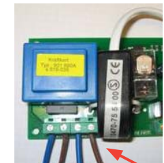
Figur 8 - Inkoppling av två eller flera UV-ramar. Matning till ramen direkt från plint
