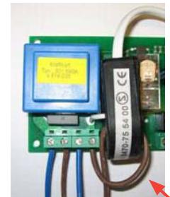
Figur 7 - Inkoppling av 1 st UV-ram. Matning till ramen genom strömmätaren
