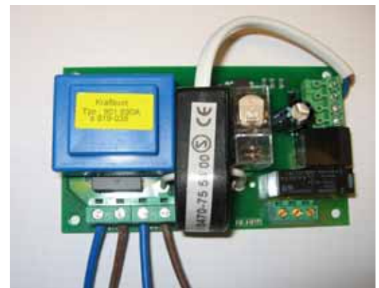
Inkoppling av 2 eller flera UV-ljusramar. Matning till ramen direkt från plint.
