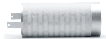
CV 100 i perforerad aluzinkplåt med fibersäker och vattentät skyddsväv. Kanalen är försedd med fästbleck. Diameter Ø100 mm. Håltagning: Ø105 mm
