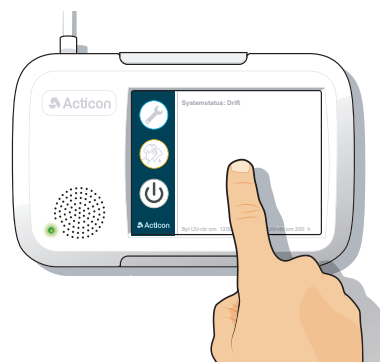
Manöverpanelen aktiveras när man trycker på skärmen. Lysdioden (LED) längst ner till vänster lyser grönt vid drift.
