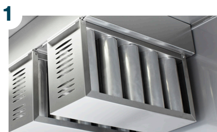
1. I cyklonfiltret sker avskiljningen med centrifugalkraft. Fett kondenserar mot cyklonens vägg och rinner ner i uppsamlingskärl
