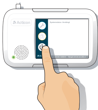
Figur 16 - Tryck på "on/off" och systemet startar
