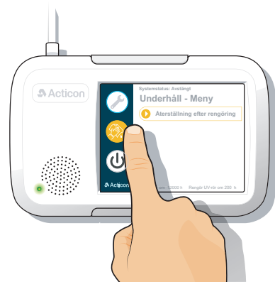
Figur 9 - Tryck på "Återställ efter rengöring"
