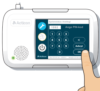
Figur 13 - Ange pin-kod 1992 och tryck OK
